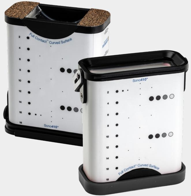
Sun Nuclear的Sono410模体符合ACR超声QA指南。它包括两个专利扫描表面-弯曲和平坦-精确的性能和均匀性测试凸和线性换能器。
