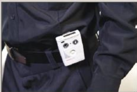
佩戴 EPD TruDose 电子个人剂量计
